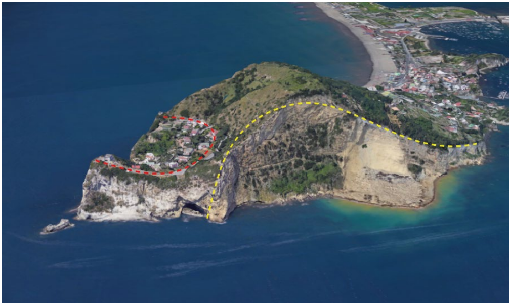
Fig. 12 – Il vulcano do Capo Miseno. La linea gialla delimita la parte del vulcano costituita da tufo giallo di scadente qualità. Si nota, in contrasto, la parte dell'edificio che si protende verso il faro costituita da pozzolane stratificate biancastre
